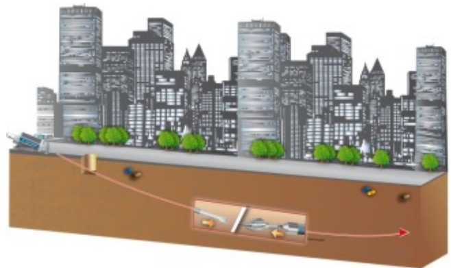
Рис. 7. Бурение в городах (вид сбоку) [55].
