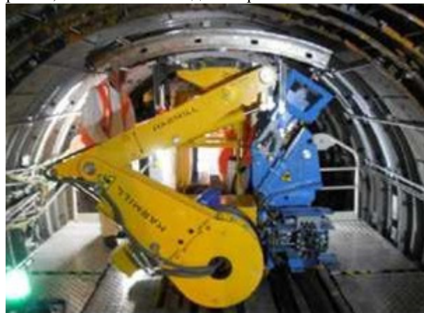
Рис. 10. Подвижной завод с роботизированной рукой обрабатывающий сегменты [16]
