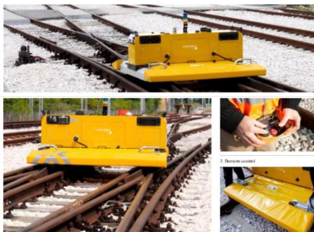
Рис.5 – Механизм (мобильный робот Felix) для осмотра железнодорожных стрелок и путей [20].
