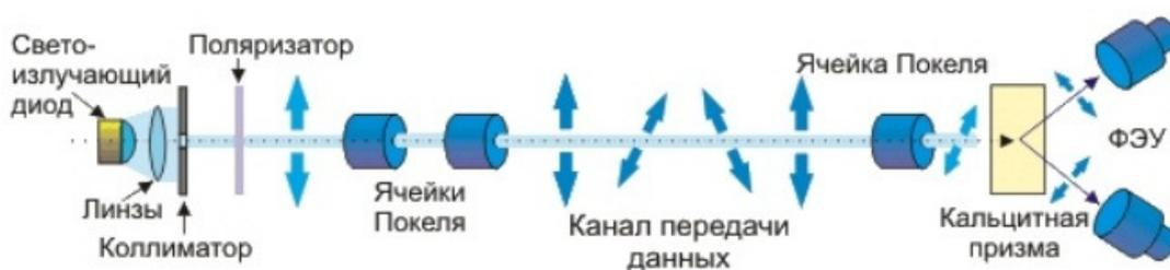
Рис. 3. Схема реализации квантовой криптографии
