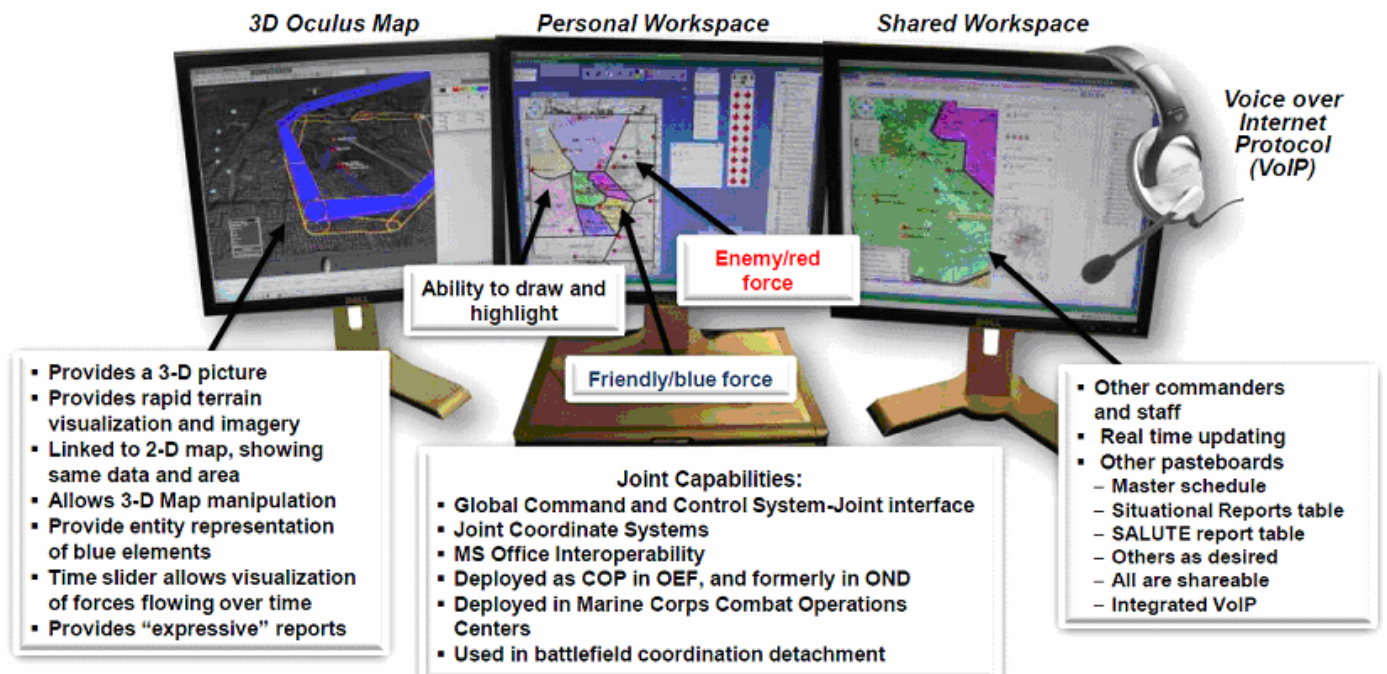
Рис. 9. Пульта управления боем на борту командно-штабной машины будущей войны: в центре – карта боя, справа – средства общения с подчиненными частями, слева – 3D средства для изучения и моделирования боевой обстановки [7]
