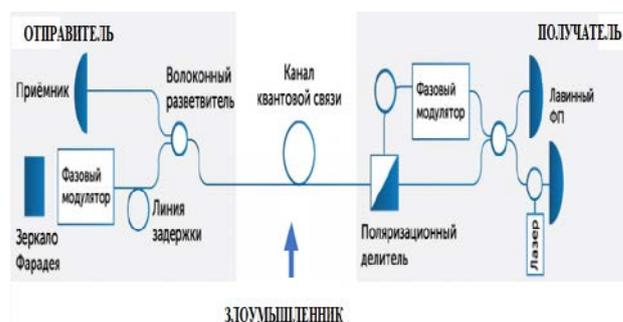
Рис.2. Блок-схема модели транзакций на основе квантовых одноразовых ключей
