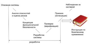
Рисунок 1 – V-модель жизненного цикла по ИСО 26262
